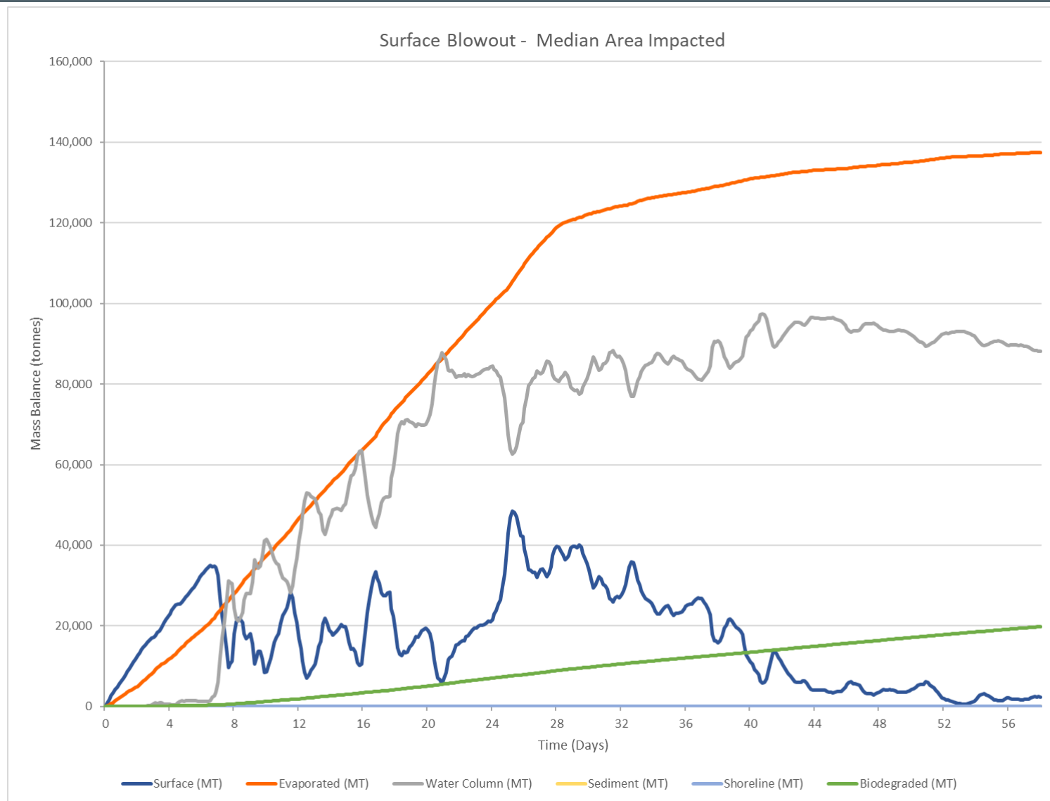
Figura 16: Gráfico de balance de masa que muestra cómo se libera el petróleo a lo largo del tiempo para una sola simulación de un reventón superficial
